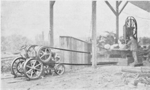
„BULLDOG“ treibt eine Bandsäge.
