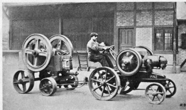
„BULLDOG“ zieht einen Steinbrecher.
